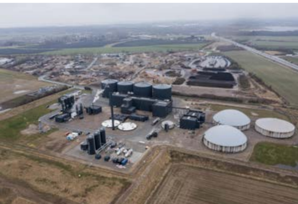
Andels elektrolyseanlæg omsætter overskydende strøm til hydrogen, og Nature Energy metaniserer organisk affald. På Glansager Biogas kombineres det til e-metan i stor skala, hvilket kan være med til at reducere udledningen af CO 2 . Jeppe Bæk, Director, Project Innovation, og projektleder på byggeriet, har haft flere hundrede gæster til rundvisning på anlægget.
